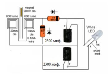
По данной схеме был изготовлен генератор Фарадея. Который выглядит следующим образом.
